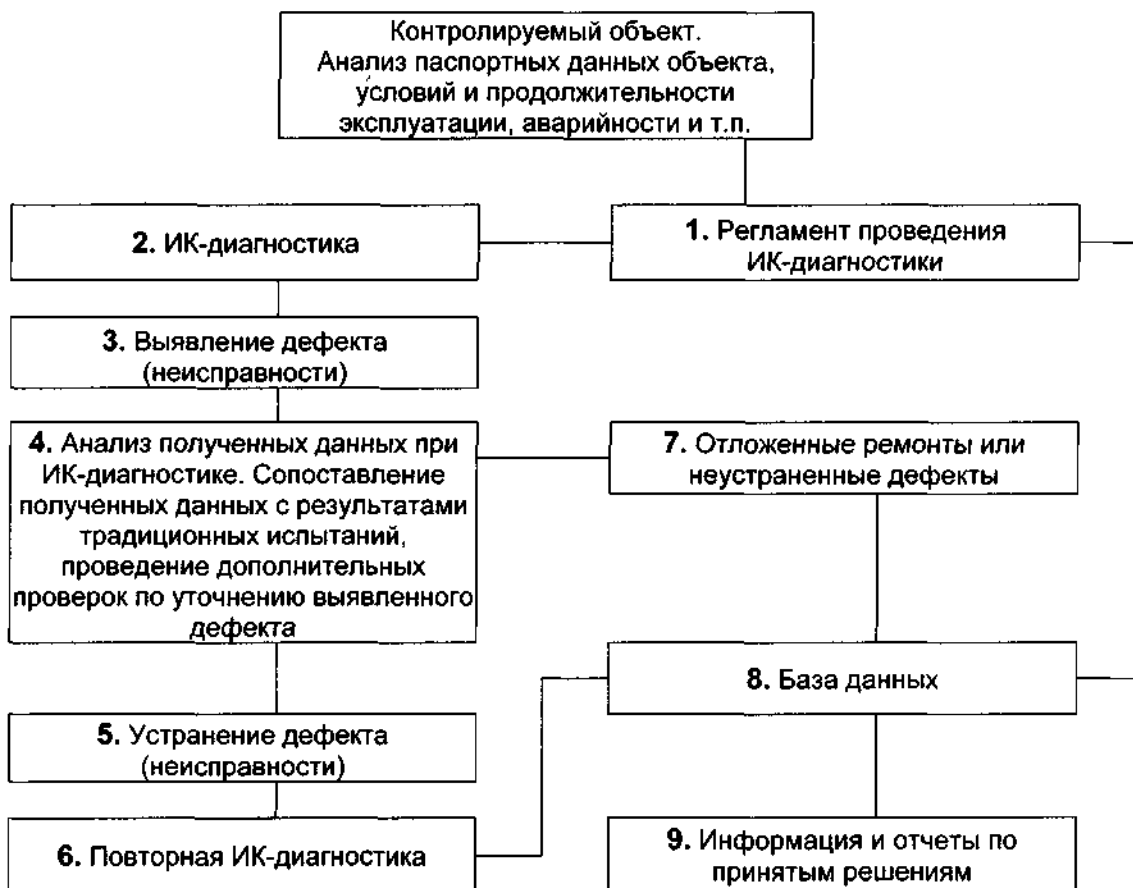
Рис.19. Принцип организации системы ИК диагностики
